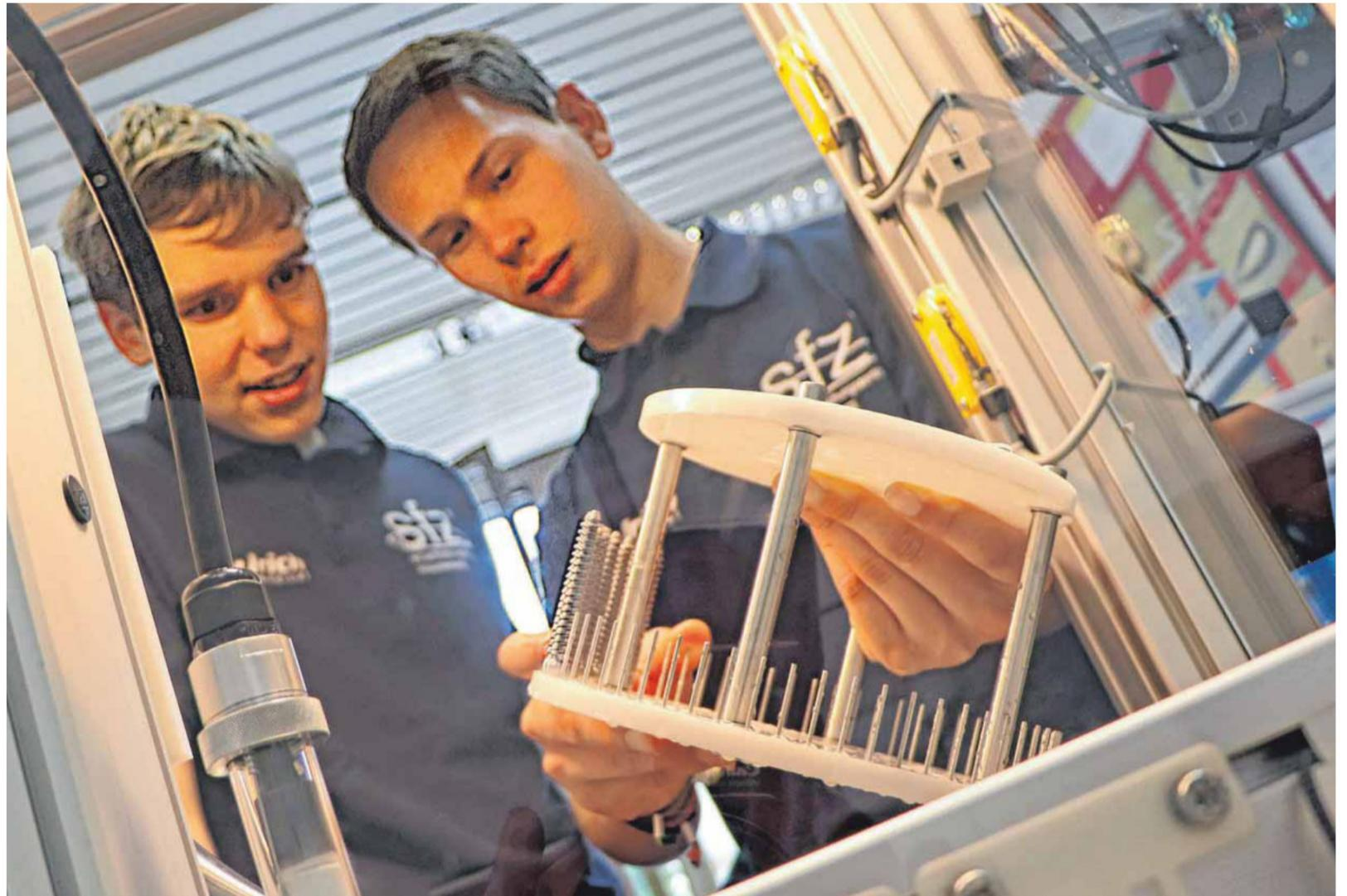
Blick in die einmalige Maschine: Jonas Münz (links) und Jakob Rehberger (rechts) fixieren die Titanschrauben für die Ultraschallbehandlung.
